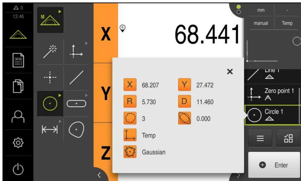
Figura 55: elemento **Cerchio** con **Anteprima elemento** per il rilevamento dei punti di misura senza sensore
