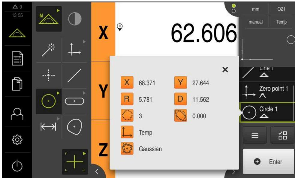
Figura 56: elemento **Cerchio** con **Anteprima elemento** per il rilevamento dei punti di misura con sonda OED **Croce ottica**
